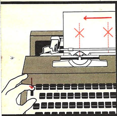
Per annullare un singolo arresto portare il carrello nella posizione da annullare e spingere verso il basso la leva 14.
