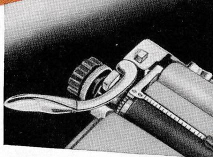
Leicht und bequem ist das Typenreinigen und das Auswechseln des Farbbandes. Wagen etwas nach links, Abheben der Deckkappe, und schon kann man zu Typen und Farbbandspulen.
